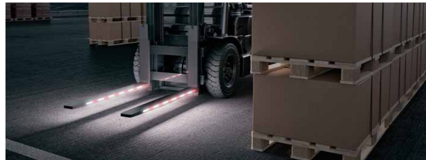
Diody LED zintegrowane z częścią nosną widły. Funkcja ostrzegania w niewidocznych miejscach.
