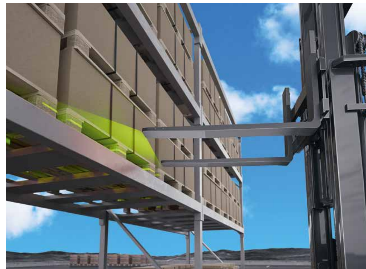
Precyzyjne celowanie. Zielona linia lasera w czubku widły.
