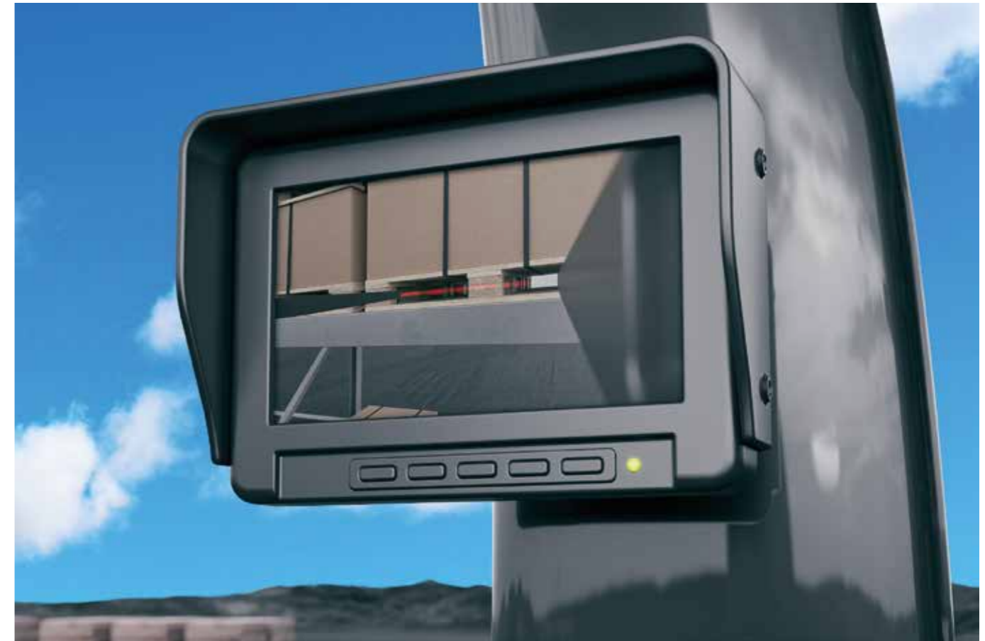
Widok z monitora w kabinie. Celowanie wzdłuż widet.
